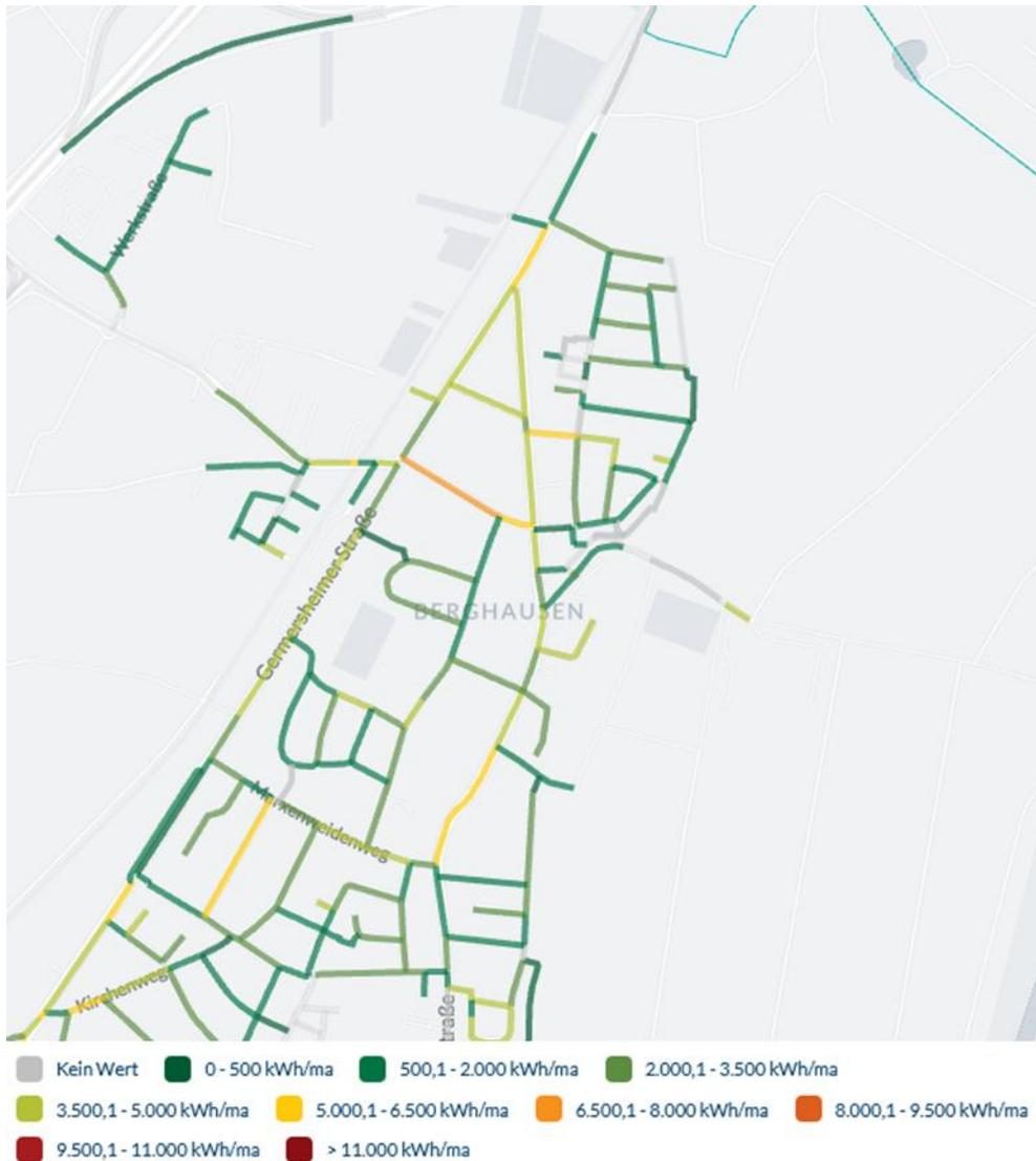
Abbildung 30 Wärmeliniendichte Römerberg-Berghausen
