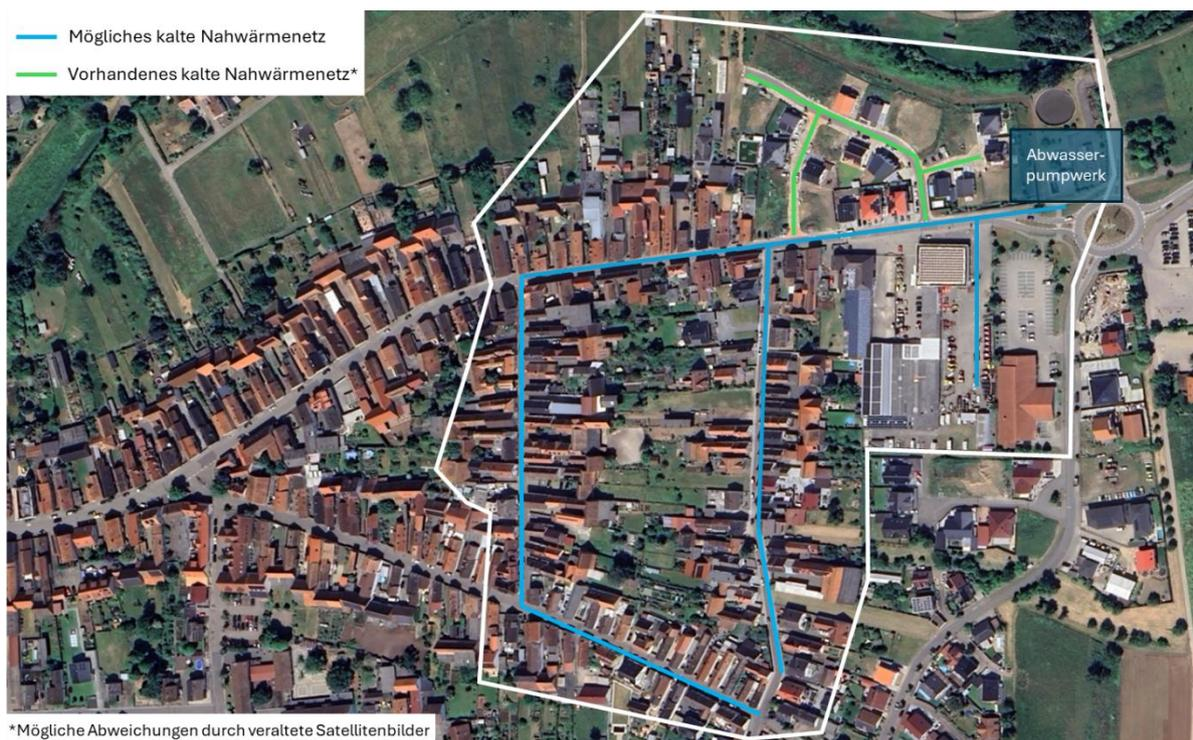
**Abbildung 52 Fokusgebiet Harthausen inklusive möglichem kaltem Nahwärmenetz und Erzeugungsanlage**
