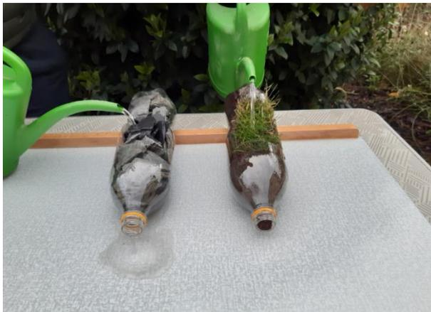
Das Experiment macht deutlich, dass die mit Erde und Bepflanzung befüllte Flasche das Wasser deutlich besser speichert als die mit Schiefersteinen befüllte Flasche.
